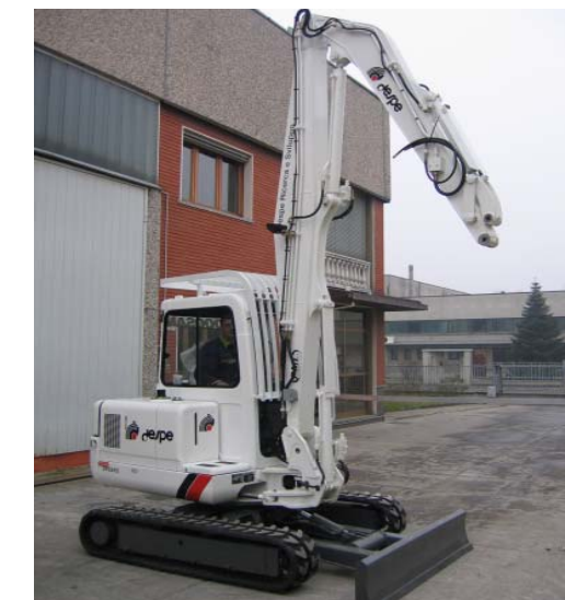
Peso operativo 3.5ton, altezza al perno braccio 7.2m, peso pinza 400 kg
